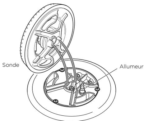
Positionnement correct du diffuseur de flamme - brûleur double
