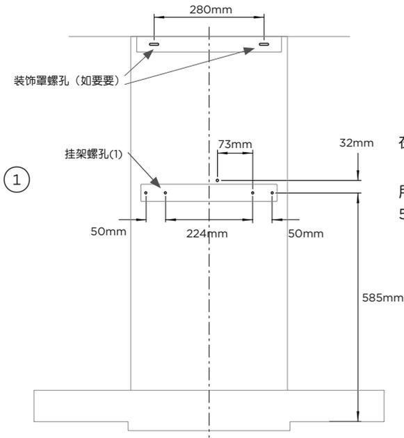
在墙上标出挂架、止动螺丝和上烟管支架（如果使用烟管支架）的位置。
