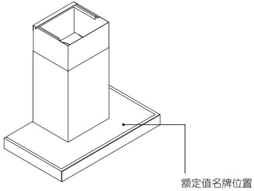
在连接吸油烟机电源之前，确保额定值铭牌标注的电压和频率与安装点的电压和频率一致。
