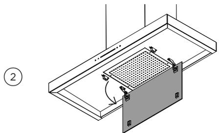
打开卡扣拉出导风板即可看到滤油器。
