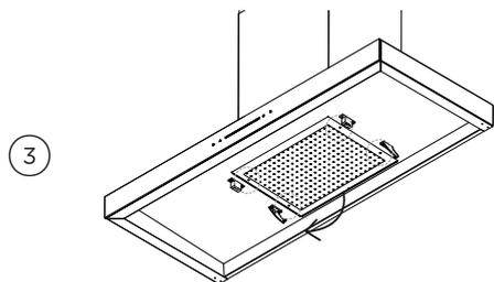
拆卸滤油器4个固定螺丝把它拉出来。
