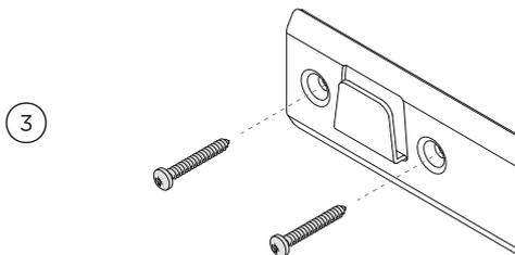
用安装螺丝把挂架和上烟管支架安装在墙上。
