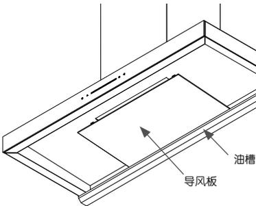
安装油槽和导风板。
