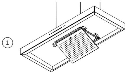
把过滤器顶部插入过滤器安装槽。确保对准卡片。
