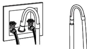
Installation du tuyau d'évacuation
