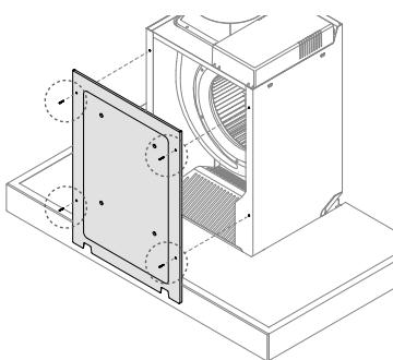
重新主机外壳盖板，然后拧紧螺丝固定主机外壳盖板。
