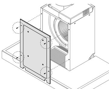
松开主机外壳盖板固定螺丝拆卸盖板。
