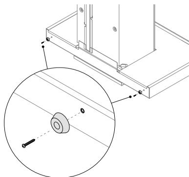
用随机提供的螺丝把支脚安装在吸油烟机背面。
