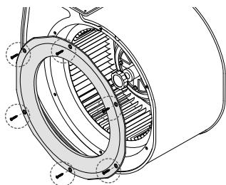
重新安装进风圈，然后拧紧螺丝固定进风圈。
