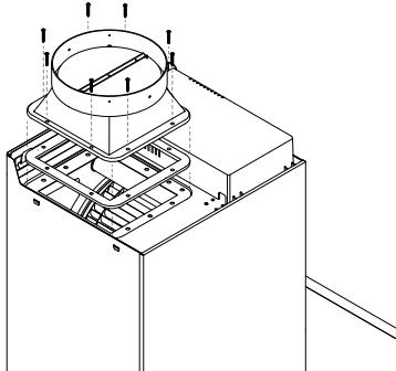
把止回风门密封条和止回风门组件放在吸油烟机顶上的出气口上。
