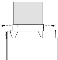
把排气管置于止回风门组件上，然后拧紧螺丝固定排气管。
