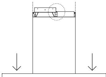
把吸油烟机重新挂到墙壁上的挂架上，然后拧紧止动螺丝固定吸油烟机。
