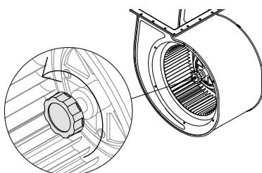
重新安装风扇，然后反时针旋转螺母固定风扇。
