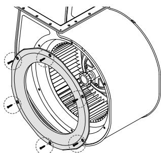
松开进风圈固定螺丝拆卸进风圈。
