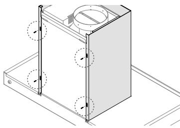
重新安装内外烟管罩，然后拧紧螺丝固定内外烟管罩。
