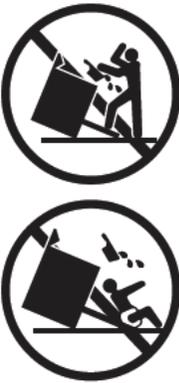
Pour réduire les risques de basculement de l'appareil, vous devez fixer celui-ci en installant correctement le dispositif antibasculement emballé avec l'appareil.
