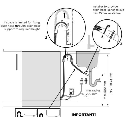
DRAIN HOSE JOINER ONTO SINK TRAP/WASTE TEE
