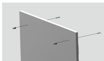
Richten Sie die Sperrstifte an der Vorderseite der Blende aus, bevor Sie die mitgelieferten Schrauben von der Rückseite der Blende einsetzen.
