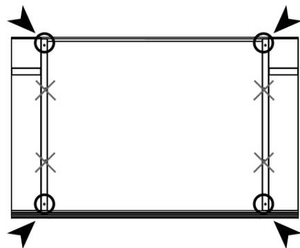
Assemblez l'Encadrement en utilisant les emplacements des trous de vis indiqués.
