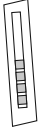
Papier réactif à la dureté de l'eau (inclus dans le guide de sécurité imprimé)
