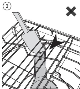
**3 Der/die Sprüharm(e) müssen korrekt montiert sein und frei rotieren können**
