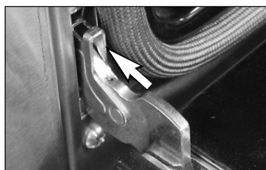
Fig. 21 Clip de retenue de charnière en position verrouillée
